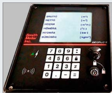
A jövedéki termékek mérésének számítóműve, a GEOFLO
