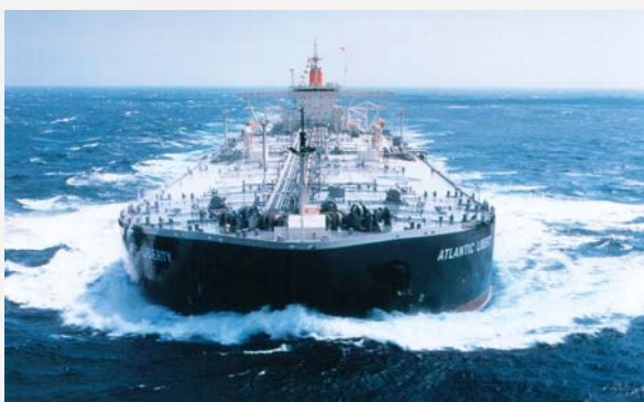
VLCC – very large crude carrier („nagyon nagy méretű kőolajszállító tanker”)
