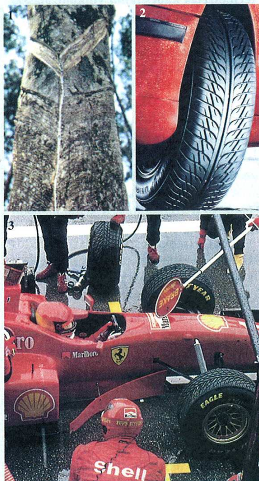
52.1. Kaucsukfa (1). A korszerű, különböző keménységű és futófelületű gumibroncsok vulkanizált műgumiból készülnek (2, 3)
